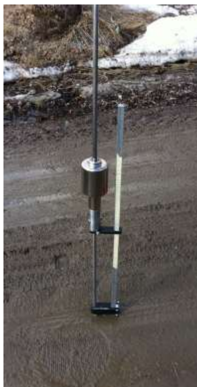
Figur 19 Dynamisk konpenetrometer (DCP) vid mätning i Sunne.
