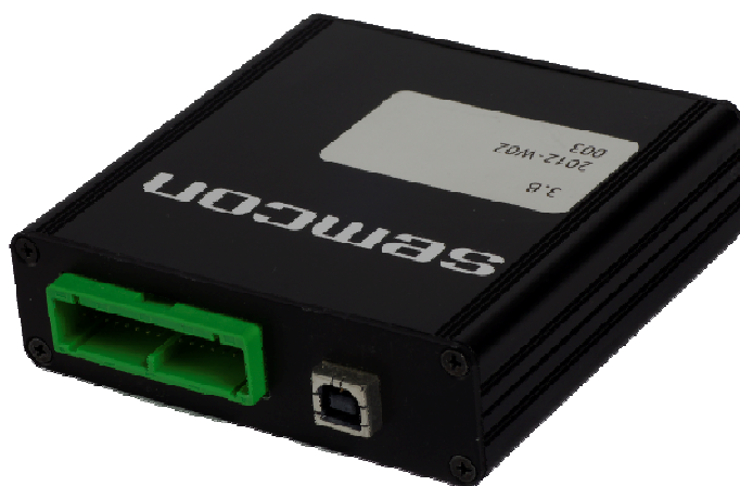
Figur 11, Hårdvarulösning med synlig JAE-kontakt och USB
