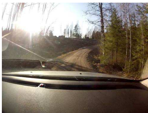
Figur 61: Mät punkt 6 Teststräckan på Edanehalvön öster om Arvika. 14 Mars. Ytuppmjukat, ingen spårbildning.
