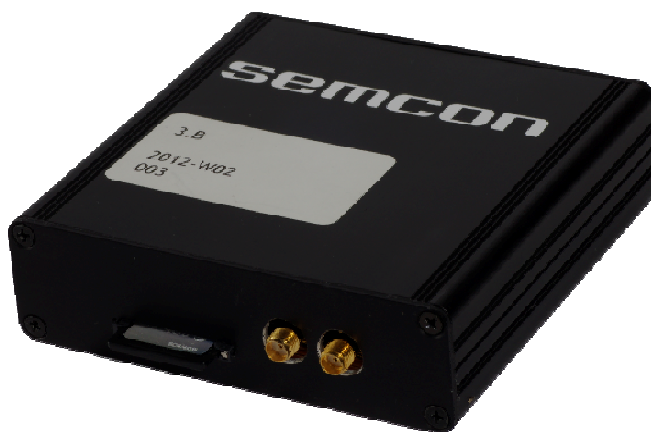
Figur 10, Hårdvarulösning med synligt SD-kort, GSM- och GPS-ingång
