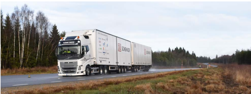
Bild 5.4.7 Prestandatest på provbana, DUO-Trailer
