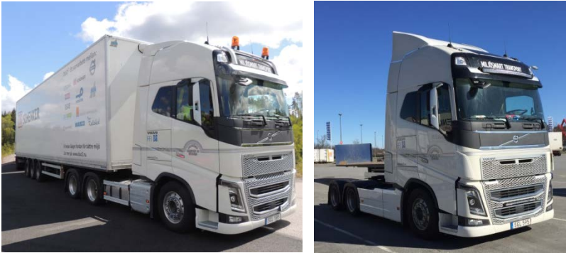
Bild 5.4.4 Aerodynamikförbättringar DUO-Trailer a) före ombyggnation b) efter ombyggnation
