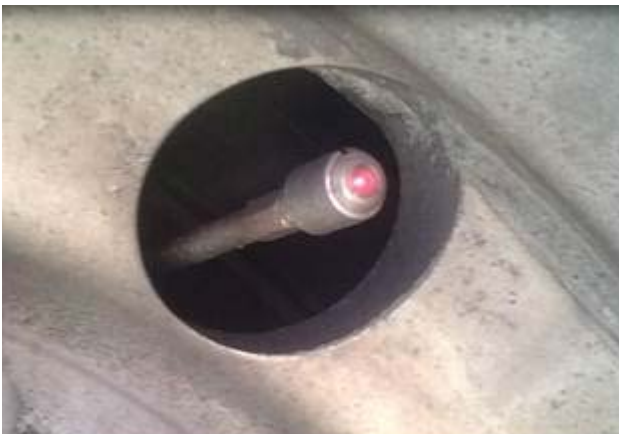
Bild 5.3.3 Indikator där däckstrycket har sänkts med minst 0,4 bar
