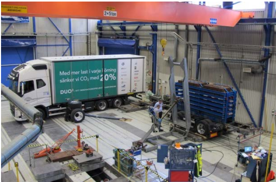
Bild 5.4.6 Statiskt välttest, DUO-Kärra
