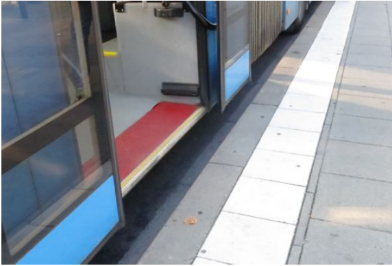
Bild Angöring mellan ledbuss och hållplatskant på bussväg i Göteborg. Rak inkörning gör att avståndet mellan bussgolvet och hållplatsytan är litet, ca 5-10 cm.
