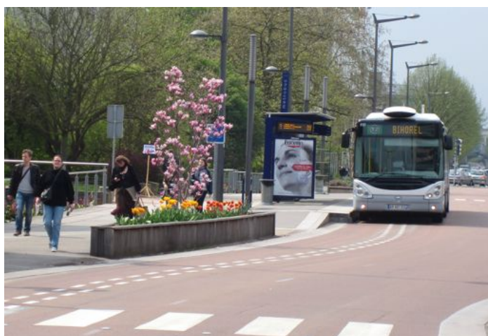
Figur Samspel mellan fordon, körbana och hållplats. Dessa BHL-fordon i Rouen styrs optiskt via en målad linje i körbanan och det sker mest vid och i närheten av hållplatser. Insteget är plant och avståndet mellan buss och plattform endast några centimeter. Foto: Karl Kottenhoff 2012?.
