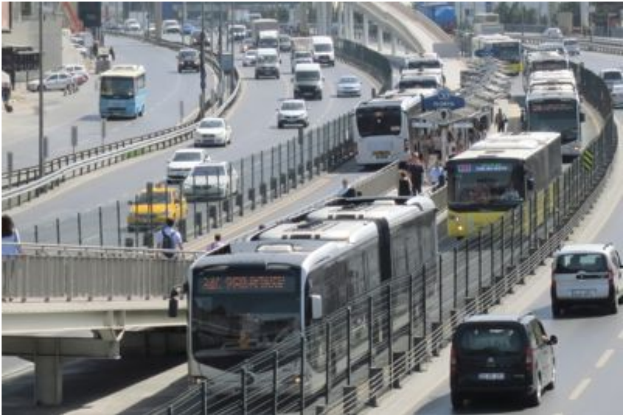
Figur En Metrobus-station mitt i motorvägen. Observera att BRT-bussarna körs i vänstertrafik för att lätt kunna angöra stationerna från full fart (70-80 km/tim).
