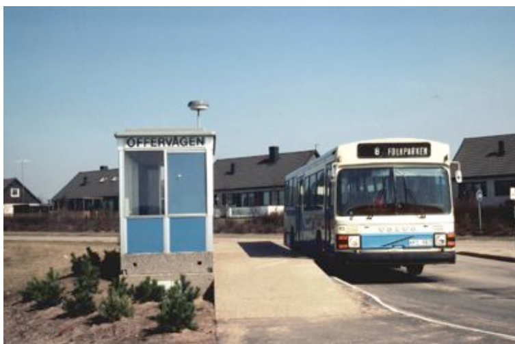
Figur Volvos bussystem i Halmstad 1979 med en halvhög plattform och elektroniskt styrd inkörning till hållplatsen. Foto: PG Andersson?
