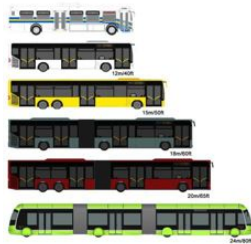
Figur Olika utföranden och storlekar på bussfordon. Överst visas vanliga 12m stadsbussar, den första från USA, därefter en 15m boggibuss och en 18 m enkelledad buss. De två nedersta fordonen används för BRT där fordon med hög kapacitet och speciell utformning önskas. 20m-fordonet är en Mercedes med dubbla bakaxlar som används i bl.a. Istanbul "Busmetro". 24m BRT-fordonet är Van Hool och det finns i Metz, och i Malmö.
