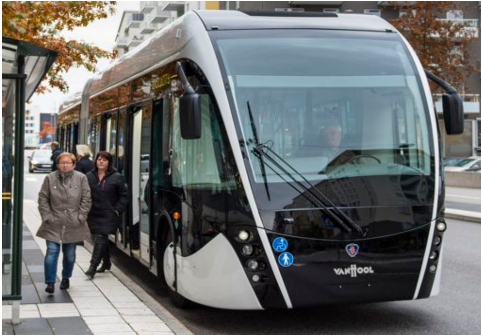
Figur Scania ExquiCity prototyp på provtur. Fordonet är en 18,7 m lång BRT ledbuss, av Scania avsett att passa svenska BRT-system.
