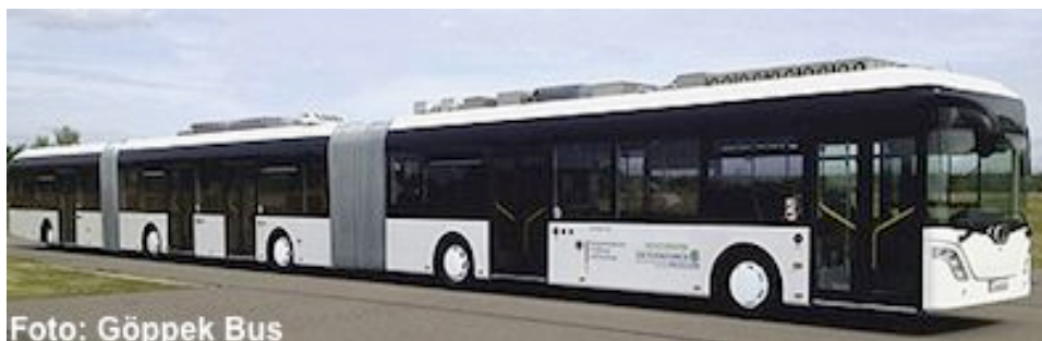
Figur En 30,7 m lång prototypbuss med fem axlar från Göppeck Bus. Fordonet kallas AutoTram. I Sverige för bussar längre än 18.75 m inte framförs utan dispens. Exquicity för Malmöexpressen är 24 m.
