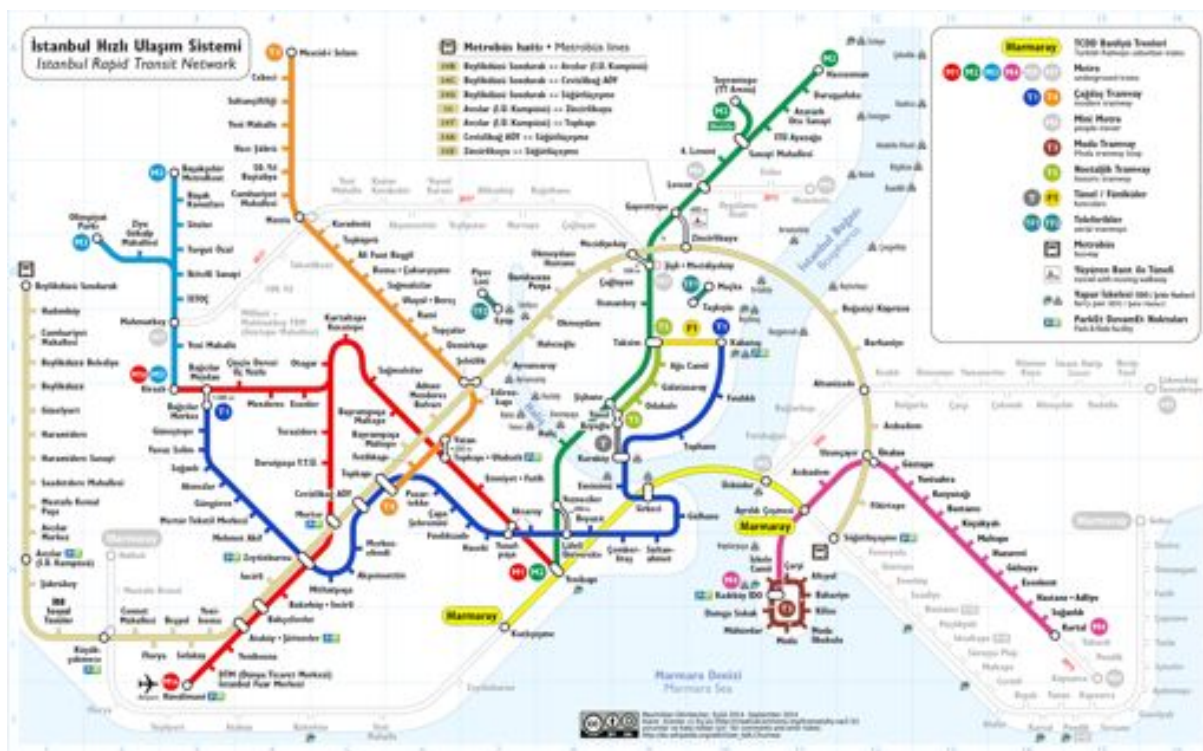
Figur Karta över kollektivtrafiksystemet i Istanbul, ca 2013. BRT-korridoren Metrobus med busslinje nummer 34 sträcker sig ca 52 km från nordväst i den Europeiska delen i till den Asiatiska delen i öster. Linjen har 45 stationer och medelhastigheten är 40 km/tim inkl. hållplatsstopp.
