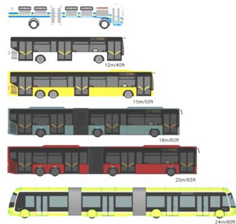
Figur Olika typer fordon som anses passa för BRT (källa: .....). Det nedersta fordonet är speciellt utformat för BRT och BHLS-trafik av tillverkaren VonHool. Den 20m långa ledbussen används för BusMetro i Istanbul där de går i 15-sekunderstrafik under rusningstid.
