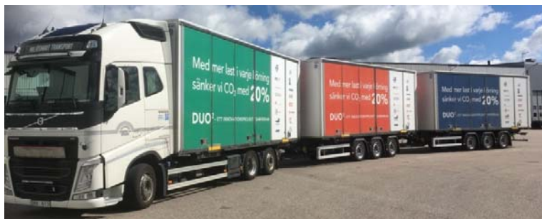
Figur 16: DUO-kärra med treaxliga kärror
