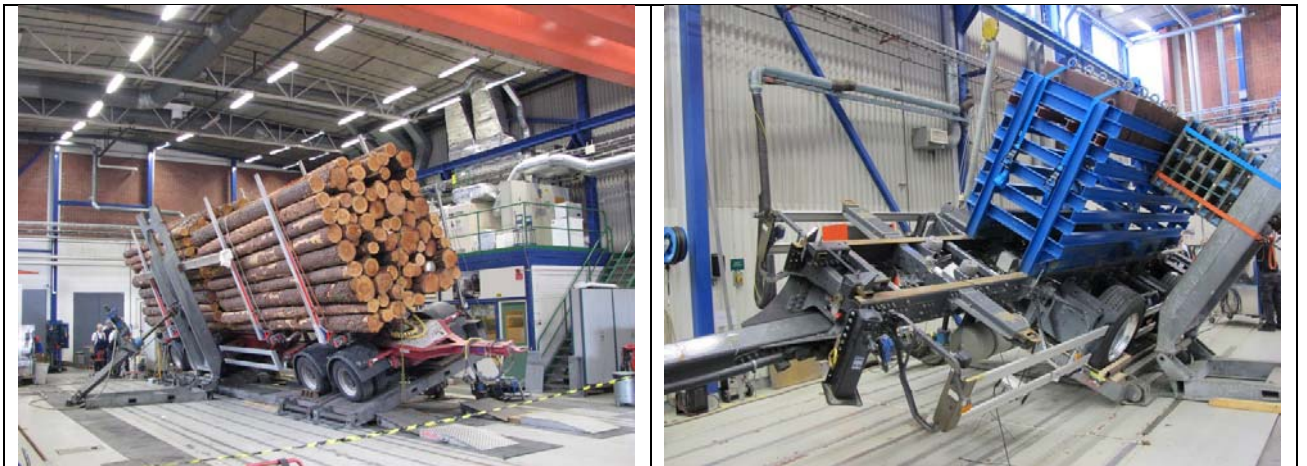
Figur 59, Tidigare prov har visat att vältgränsen för en 4,5 meter högt lastad timmersläpvagn typiskt kan vara så låg som 3,0 \text{ m/s}^2 (vänster). Ett annat prov (höger) har visade att singelmontage gav hela 10% högre vältgräns än dubbelmontage, vilket beror på spårviddsskillanden.
