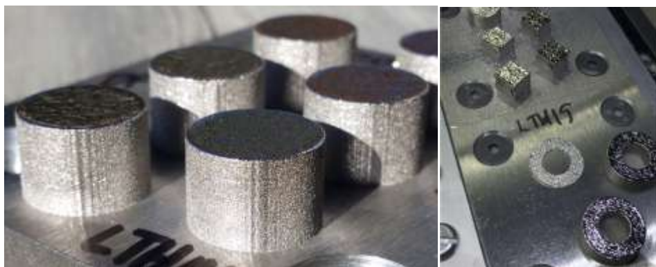
Figur 4. Provbitar tillverkade med DMLS (pulver nr 3).
