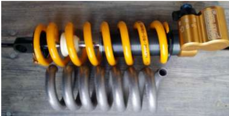
Figur 9. Prototypgeneration tre tillsammans med standardfjäder monterad på stötdämpare för mountainbike.
