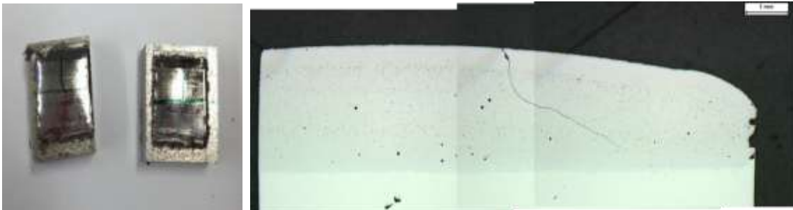
Figur 3. Mikrostruktur hos tvärsnitt (höger) av material från pulver 2. Den övre och undre delen är amorf medan den mellersta delen delvis kristalliserad med hjälp av ändrade processparametrar
