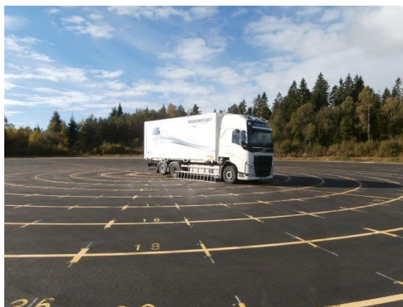
Figur 3. Lastbil under mätning av strålningsdiagram (vänster) och resulterande strålningsdiagram (höger).
