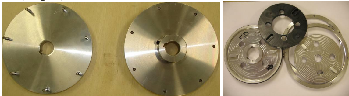
Figur 3. Vänster Stift koppling; Right Oldham koppling.
