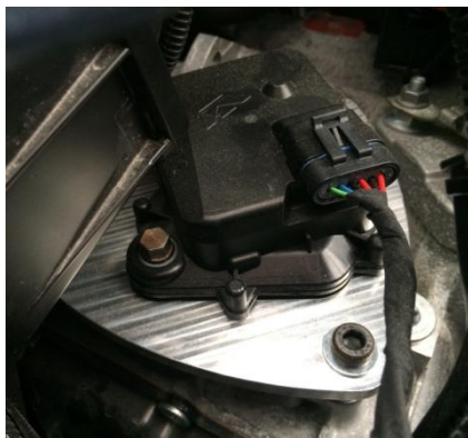
Figur 9. Top Aktuatorn monterad på demobilens växellåda; Vänster Aktuatorns närbild; Mitten Färdig ECU installerad i demobilen; Höger Växelväljaren installerad i mittkonsolen av demobilen
