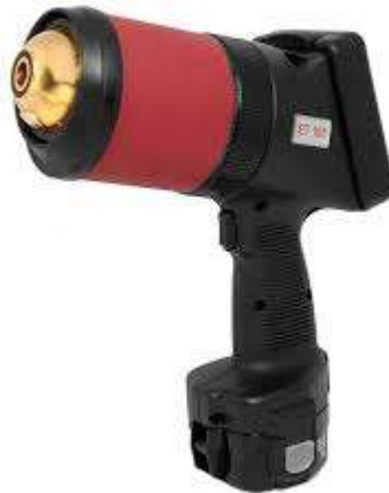
Figur 4.3.7-1 Portabel emissiometer "ET100" från Surface Optics i USA.
