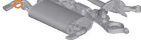
Figur 4.3.10-5. Luftmätpunkts positioner vid baksida motorkåpa och avgassystem.
