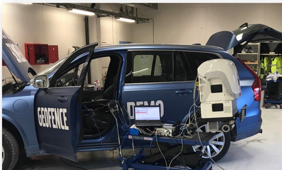
Figur 13 Visar preparering av testfordonet inför evalueringen med PEMS utrustning (Portable Emission Measurement System).
