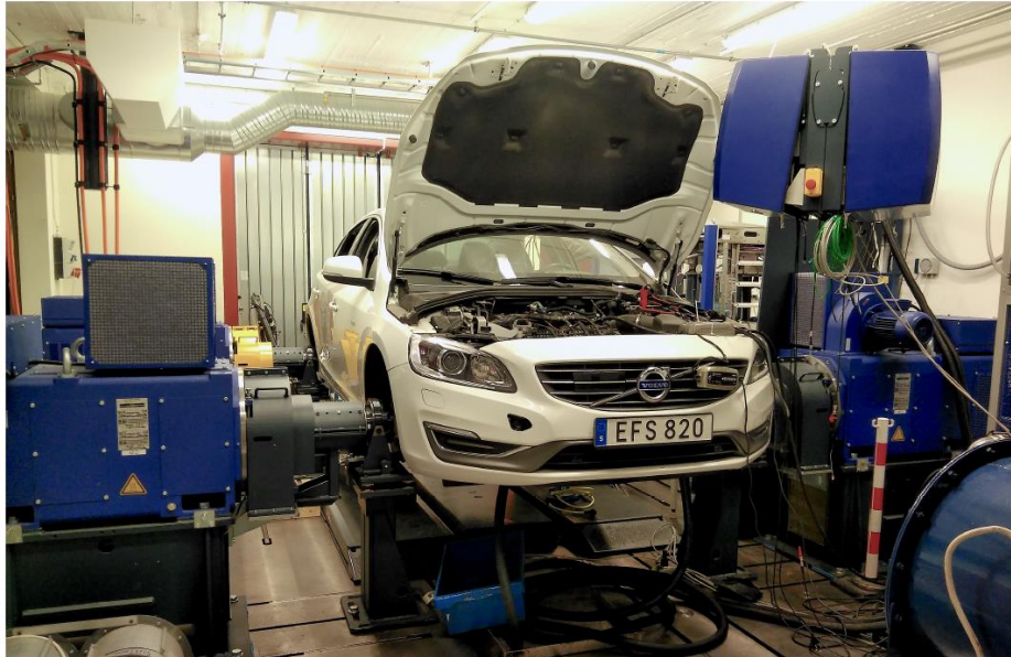
Figur 10 Riggtester med en S60 Plug-in Hybrid i testriggen på Chalmers Tekniska Högskola där mjukvaran för optimal växlingsstrategi reglering utvärderades
