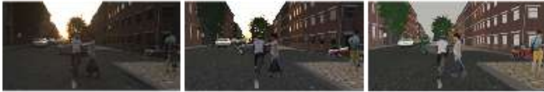
Figur 2: visar exempel på data genererad med olika metoder med varierande beräkningskomplexitet. Våra studier visar att noggrann, fotorealistisk simulering av bildsensorn är en mycket viktig komponent vid generering av syntetisk data.
