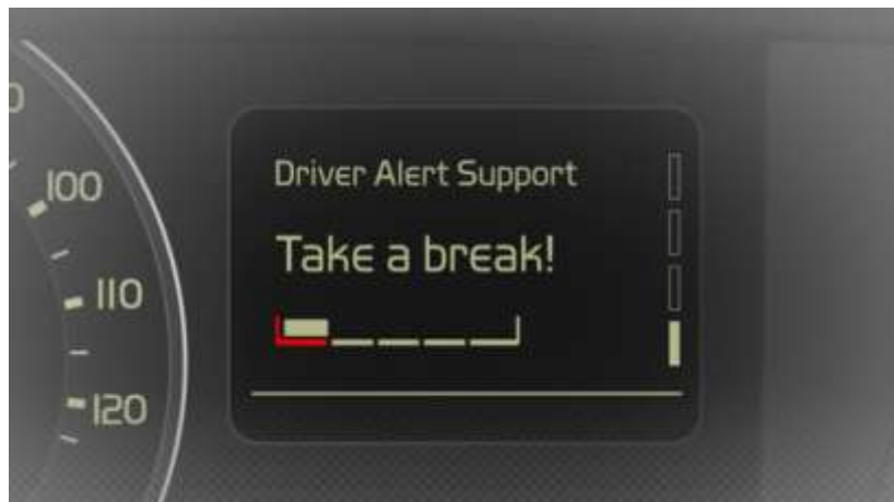
Figure 2: Volvo Driver Alert Support är ett intelligent system som analyserar körsätt. Om det skiljer sig från det normala och indikerar trötthet, så blir man varnad av en signal och får ett meddelande i displayen, som uppmanar att ta en paus
