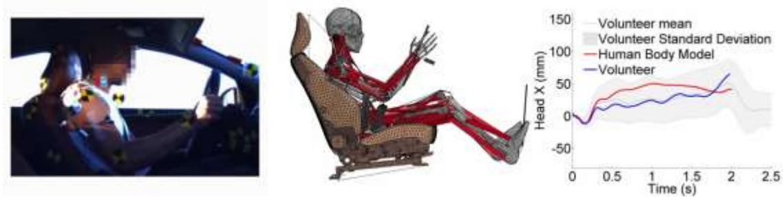
Figur 3. Responsen hos SAFER A-HBM (röd) jämfört med en försöksperson (blå), medelresponsen (grå) och korridorer med en standardavvikelse (ljugrätt område).
