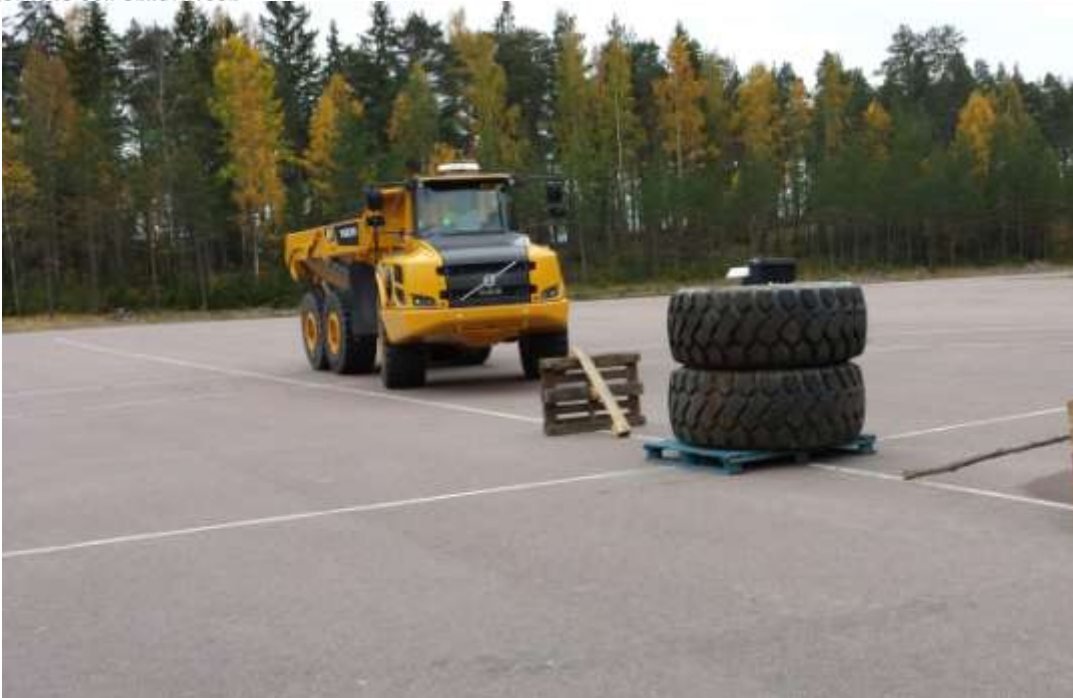
Figur 4: Dumper och hinder utrustade med systemet för automatisk inbromsning för testning och demonstration tillsammans med SARPA i Eskilstuna 2014.
