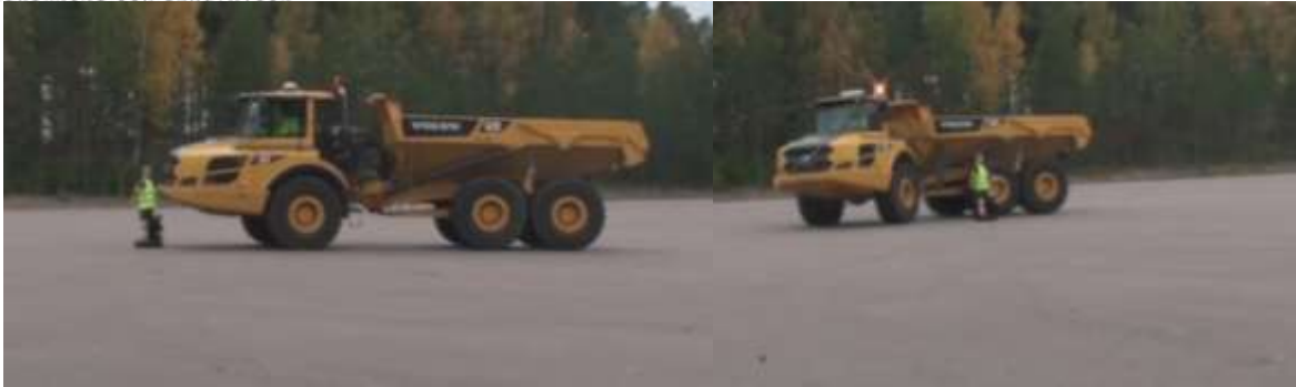
Figur 5: Bilder från filmen som spelades in vid demonstrationen av automatisk nödbroms i Eskilstuna, 2014. Bilden till vänster visar en situation när maskinen stannat automatiskt precis innan dockan körs på. Den högra bilden visar hur operatören kan köra nära dockan utan att algoritmen genererar något falskt ingrepp.
