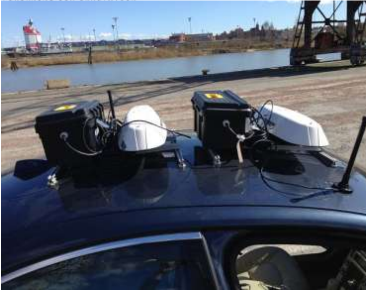
Figur 1: Två maskinenheter monterade på en personbil under den inledande testningen.
