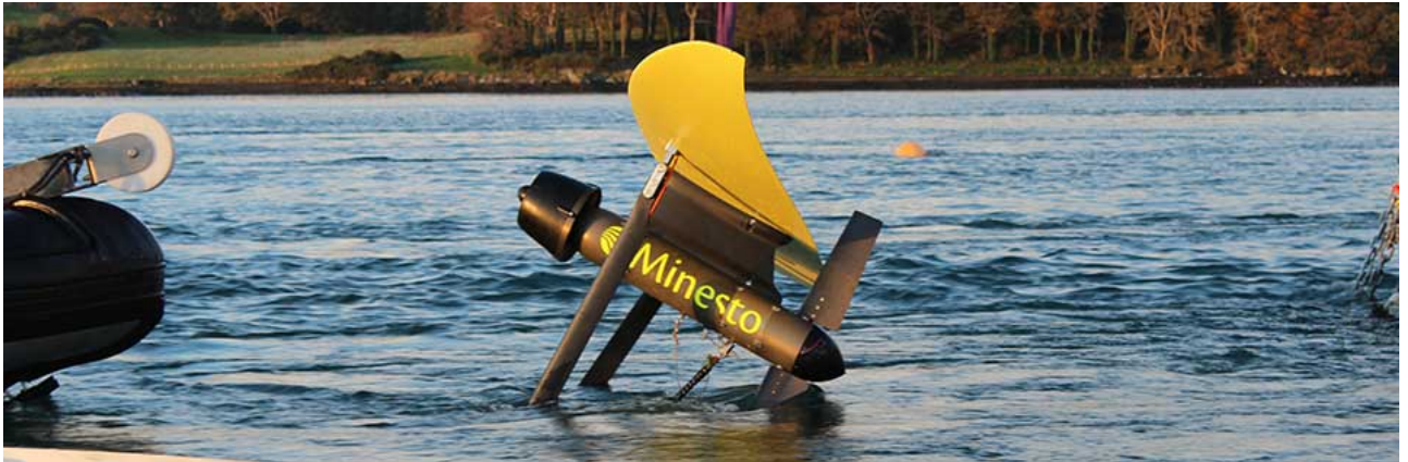
Figur 8. Utvecklingsbolaget Minesto testar sin prototyp Deep Green i skala 1:4 i Strangford Lough, Nordirland. Foto från www.minesto.se , 2014-11-11.
